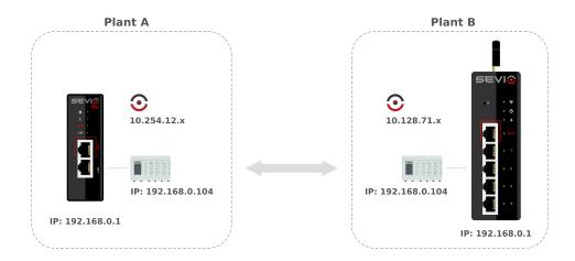
Per utilizzare questa funzione è necessario che tutti i dispositivi di automazione, oltre all'indirizzo IP, abbiano impostato l'indirizzo gateway (indirizzo LAN del Sevio Router a cui sono connessi) e i Firewall dei rispettivi Sevio Router siano abilitati.
